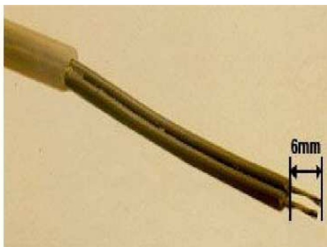
4. Очистить от изоляции контакты
